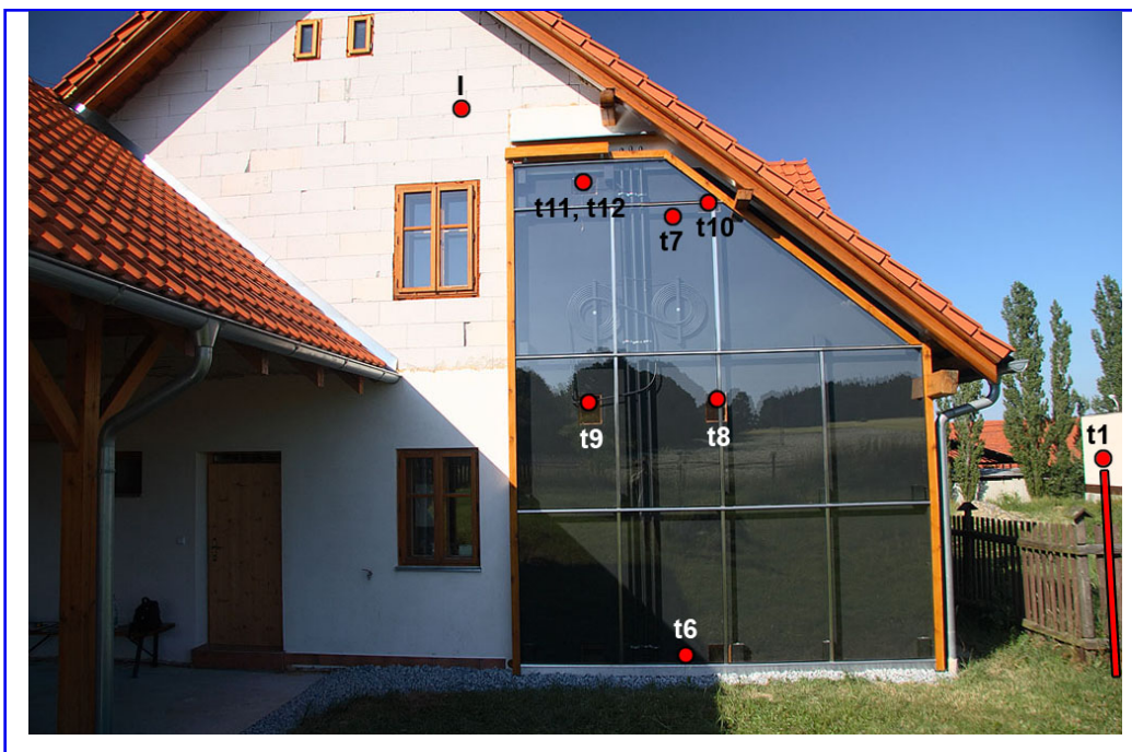
Obr. 3: Umístění čidel č. 1, 6, 7, 8, 9, 10, 11 a 12 a snímače slunečního záření I
